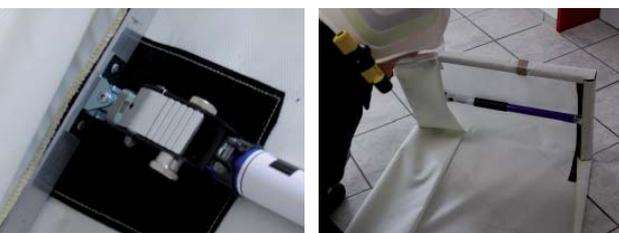
Gire la barra de refuerzo completamente en la dirección de la flecha para retratar y doble el bloqueador de humo de acuerdo con las instrucciones.
