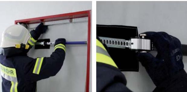
Sujete el bloqueador de humo presionándolo firmemente contra el marco de la puerta en la parte superior con la mano izquierda y use la derecha para girar la barra de refuerzo en la dirección de la flecha para apretar. Bloquee el pestillo empujando el pasador de seguridad hacia arriba.
