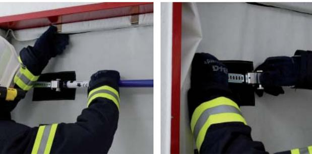
Reduzca la tensión girando la barra de refuerzo con la mano derecha en la dirección de la flecha para aflojarla sosteniendo el bloqueador de humo con la mano izquierda. Posteriormente desbloquee el pasador de seguridad, presione el pestillo y deslice las secciones del marco juntas.
