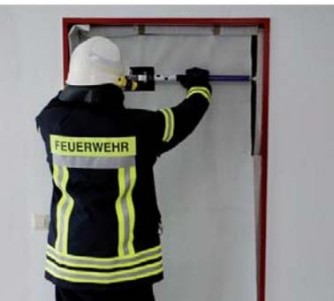
El bloqueador de humo portátil se puede instalar en marcos de puertas u otras aberturas de pared adecuadas y evita la propagación de humo y calor a las áreas de construcción que no están directamente afectadas por un incendio.
