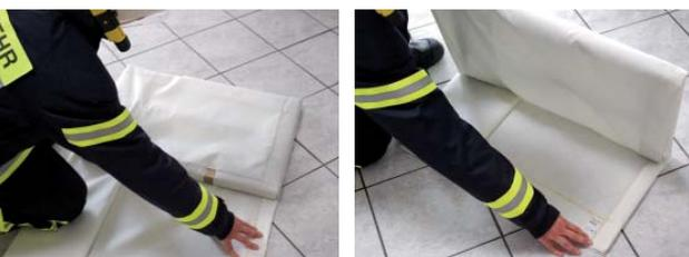
Inserte el bloqueador de humo en la bolsa de transporte con el marco cerrado primero. Se debe observar la dirección de inserción de acuerdo con la etiqueta adjunta para evitar daños a la tela durante el almacenamiento.
